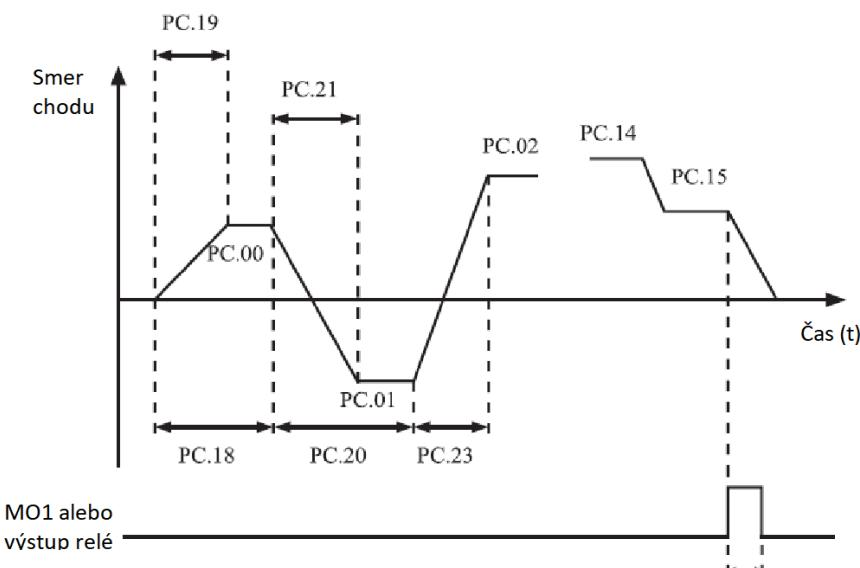
Obrázok 4-28 Jednoduchý PLC pri použití ako zdroj frekvencie
