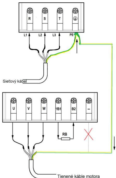
Svorky R/S/T slúžia na pripojenie napájacieho kábla. Svorka je spoločná aj pre prívod, aj pre napájaný motor.
