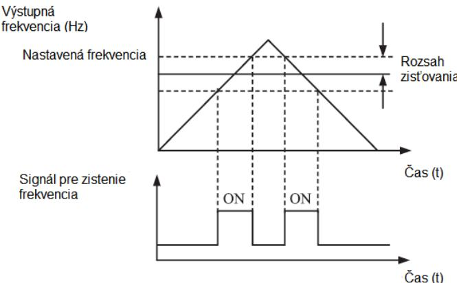
Obrázok 4-15 Rozsah detektie frekvencie
